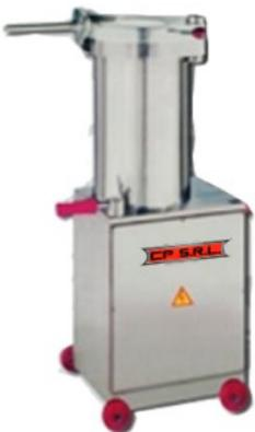
**Insaccatrice idraulica in acciaio inox, modello H20PAS**
